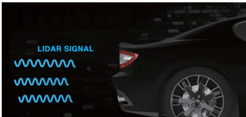
通常のカーボンブラックを使った外装塗料ではLiDAR信号の近赤外線が吸収されてしまうため応答性が著しく低下する
